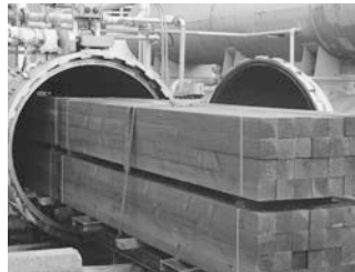
木材保存処理を行う注薬設備
