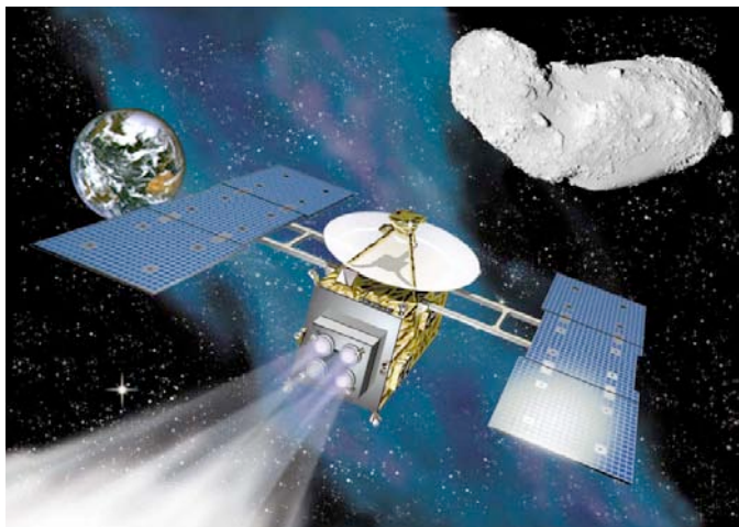
図3 宇宙動力航行する「はやぶさ」小惑星探査機。地球と小惑星は、はやぶさ探査機による実写。
