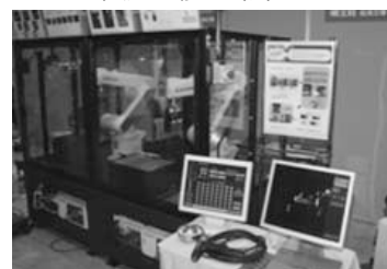
展示用に製作したロボット2台による「スタッド溶接デモ機」
