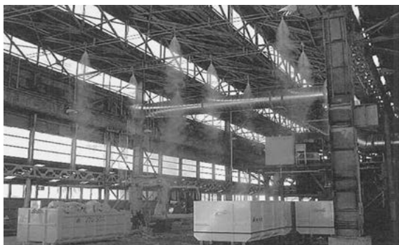
「泡」や「霧」で粉塵を抑制する装置「ダストバスタ」
