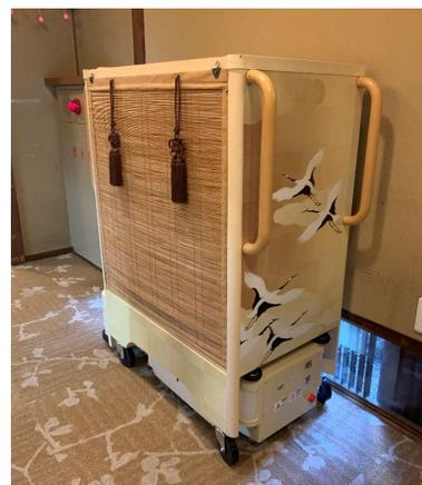
料理の運搬を支援するロボット（AGV）
