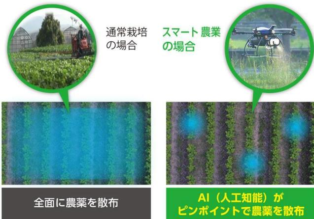
ピンポイント農薬散布システム
