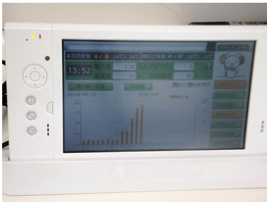
写真. 宅内表示器
