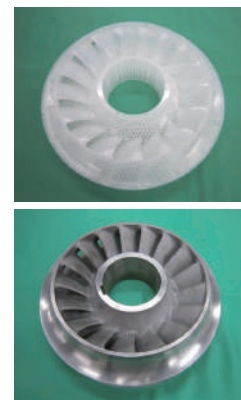
3D プリンターによる光造形モデルとモデルから置き換えられた精密鑄造品
