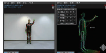
関節可動域測定装置「鑑 (AKIRA)」(左) とそれを用いた三次元計測の様子 (下)
