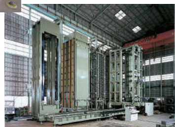
世界トップシェアの銅張積層板（プリント基板材料）製造用多段真空プレス装置
