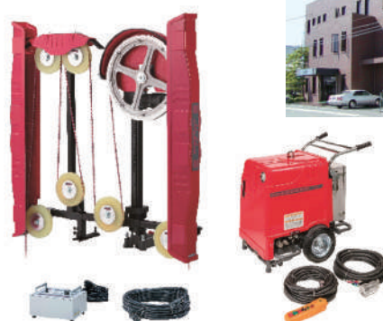
小型油圧ワイヤーソー DSM-102A (左) と油圧ユニット E-2002A (右)
