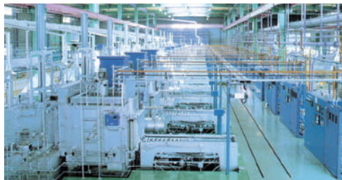
多品種浸炭焼入れの大量生産を可能とした無人化 FA ライン
