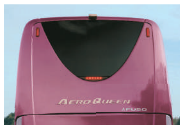
バスの後部窓に用いられた ポリカーボネート樹脂窓
