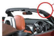
オープンカー用ウェザーストリップ （コンバーチブルシステム）
