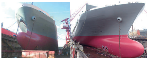
低燃費型船底塗料“SEAFLO NEO CF Z”使用実績（船底赤部分）
