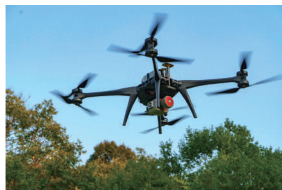
3D レーザースキャナを搭載したドローン SPIDER LX8
