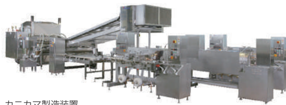
カニカマ製造装置
