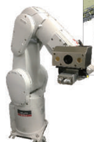
ハンドアイ3Dカメラ(YCAM3D)を搭載したロボット
